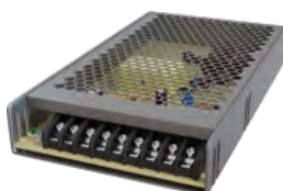
TRX004DR-150S TRX004DR-200S Драйвер 150W Драйвер 200W 100-240V DC 48V IP 20 129 × 30 × 115 мм
