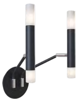
▲ MOD620WL-04B 4 × G9 25W 220-240 V, IP20 345 × 490 × 245 мм
